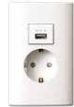
USB 충전 콘센트 USB 전원공급기 + 콘센트 1구(16A, 250V~) (입력전원 : 220V~/60Hz, 출력전원 : DC5V/2A) WLO 6611 WH
