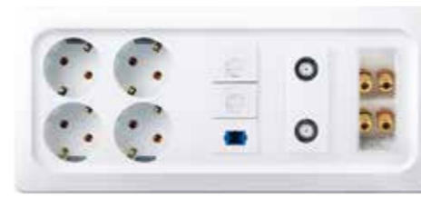
5V-A형 콘센트 안전형 30도4구 / 8P 2구+광단자 1구 / CATV+FM / 오디오 바나나잭 4P 2구 WBW 6161G WH
